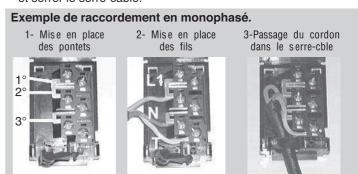
Attention : un mauvais serrage peut entraîner des risques d'échauffement dangereux au niveau du câble d'alimentation.
