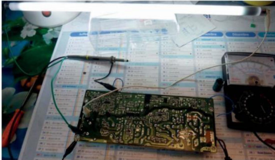
Figure 4-24. Test d'une carte inverter à l'aide d'un tube fluorescent
