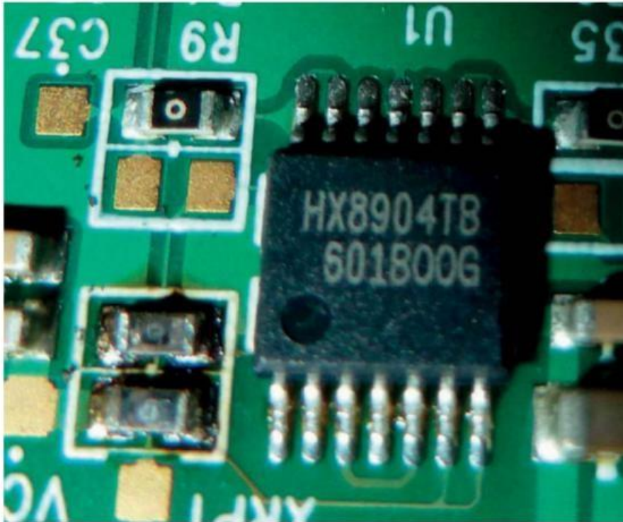
Figure 12-12. Marquage d'un circuit intégré HX8904TB (ligne 1)
