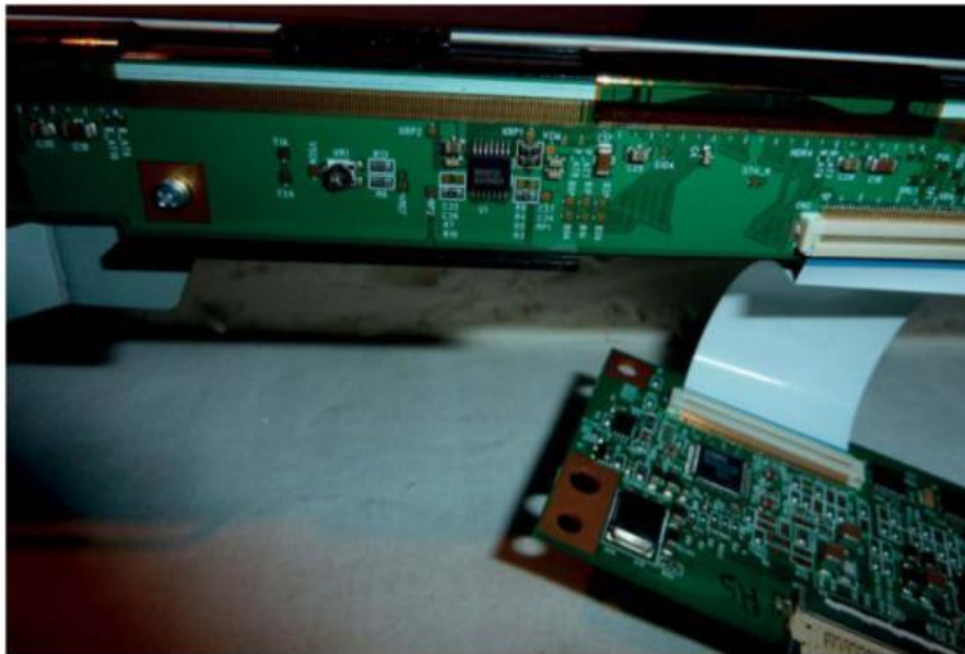
Figure 9-23. Connexion par câble plat (dalle écran LCD)
