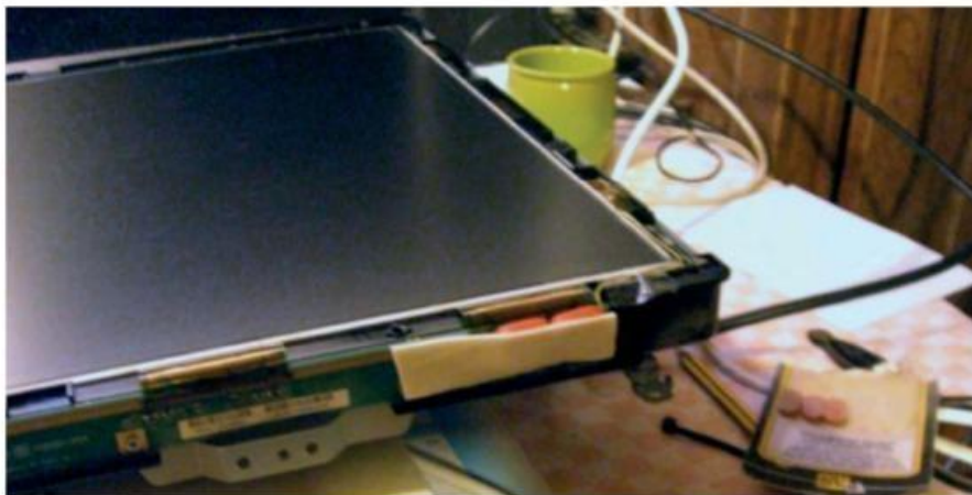
Figure 4-52. Réparation à l'aide de cales en caoutchouc et adhésif épais
