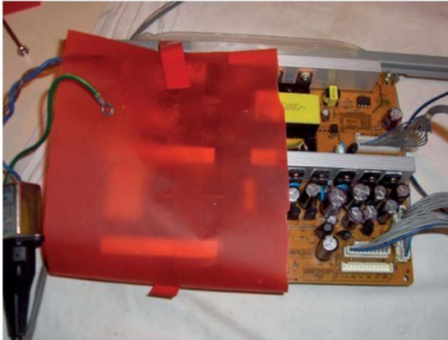
Figure 1-1. Protection d'une alimentation en cours de dépannage
