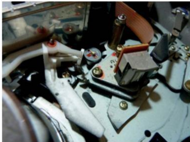
Figure 7-31. Tête d'enregistrement-lecture audio de magnéto VHS
