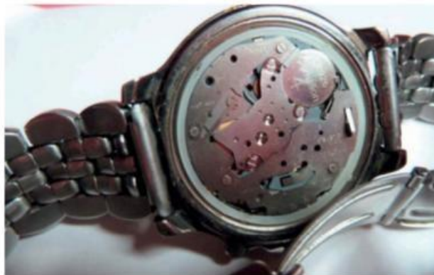
Figure 7-5. Accès à la pile d'une montre après ouverture du boîtier (fond vissé)
