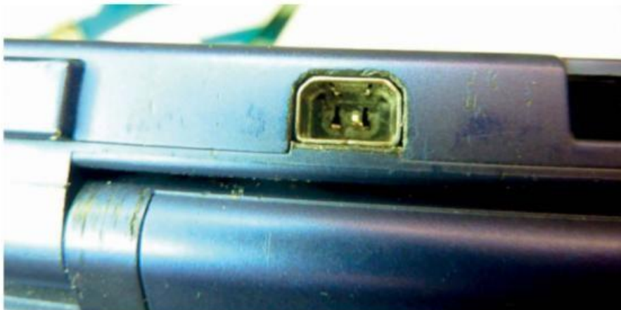
Figure 7-2. Connecteur d'alimentation d'une console de jeu détérioré
