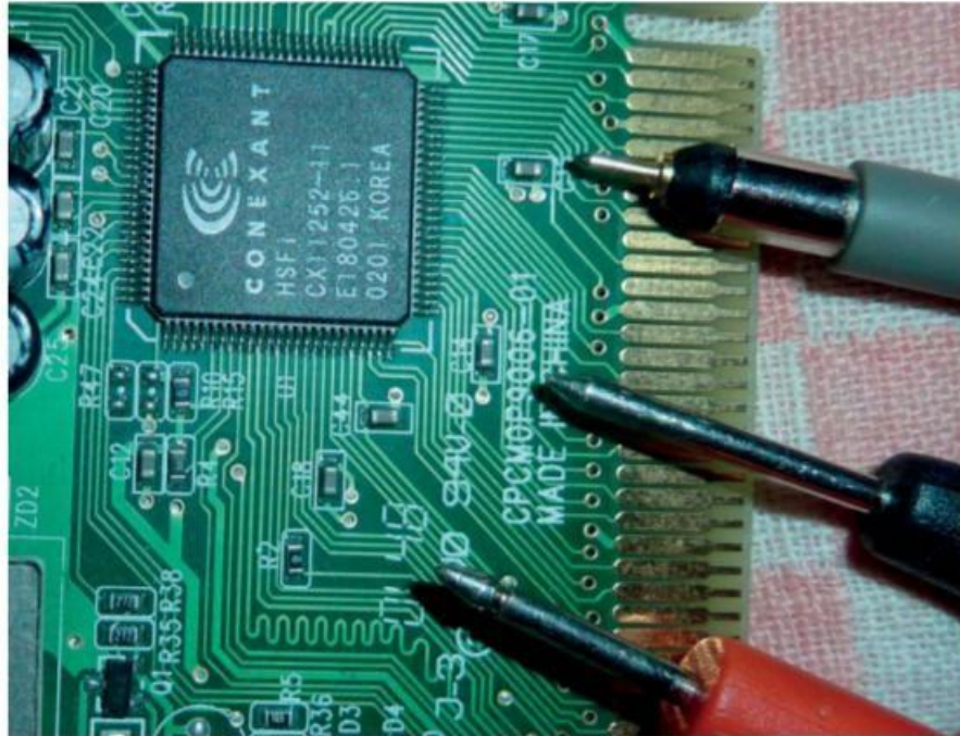
Figure 10-2. Taille comparative des pointes de touche et sonde oscilloscope
