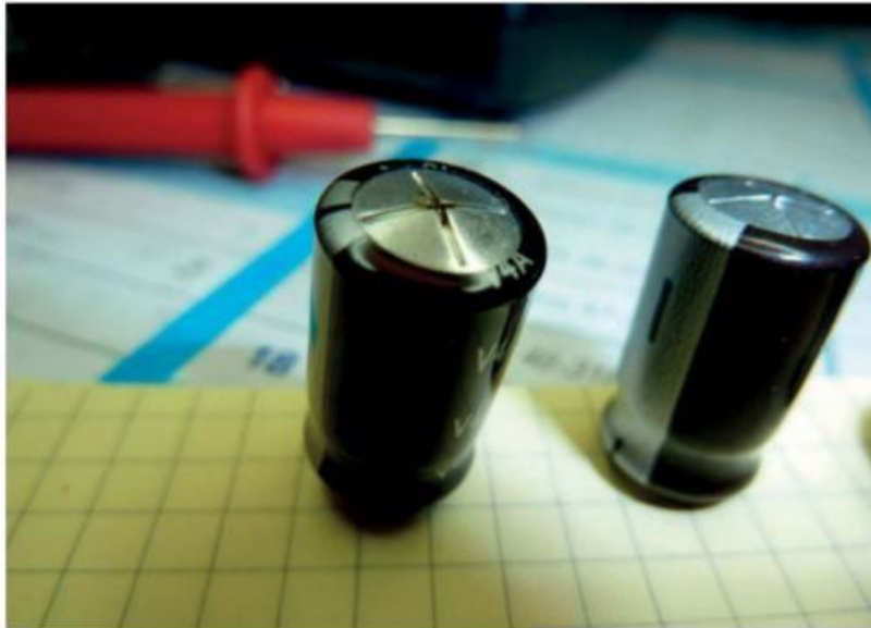
Figure 4-17. Condensateur gonflé à gauche, normal à droite
