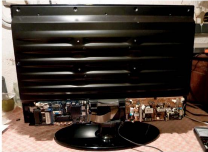
Figure 4-3. Vue intérieure d'un téléviseur récent de diagonale 26 pouces
