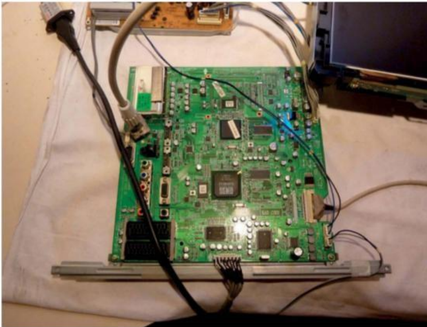
Figure 10-11. Exemple d'un téléviseur cartes démontées pour recherche de panne
