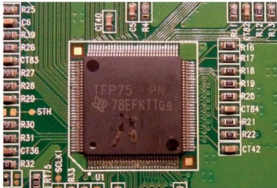
Figure 2-14. Contrôle visuel d'un composant (traces d'échauffement)
