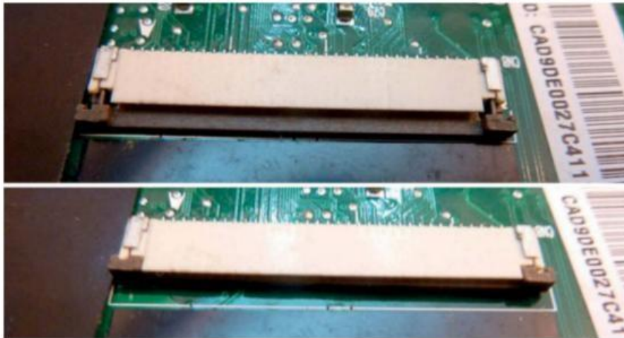
Figure 9-26. Connecteur de câble plat avec verrouillage à tirer
