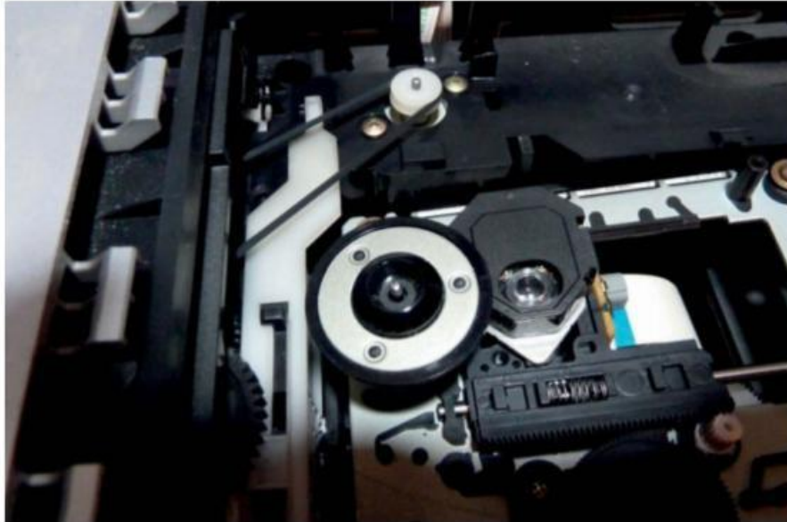
Figure 7-18. Lecteur de CD d'une chaîne hi-fi : courroie, bloc laser, platine de centrage retirée
