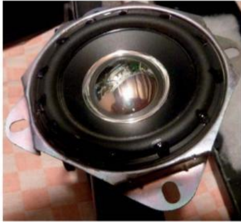
Figure 7-12. Haut-parleur à membrane détachée de la carcasse réparé à l'aide de colle.
