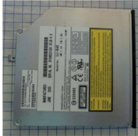
Figure 6-19. Lecteur/graveur de DVD pour ordinateur portable. Notez la patte de la vis de fixation
