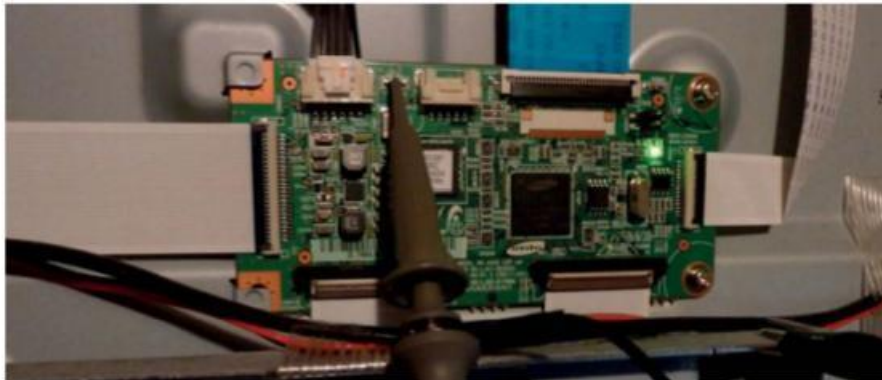
Figure 5-13. Point de test sur carte T-Con (synchronisation trame)
