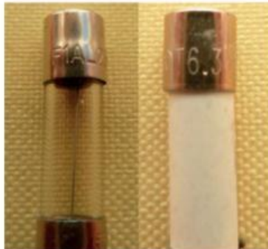
Figure 12-1. Marquage des cartouches : 1 A « fast » (rapide) et 6,3 A temporisé (lent)
