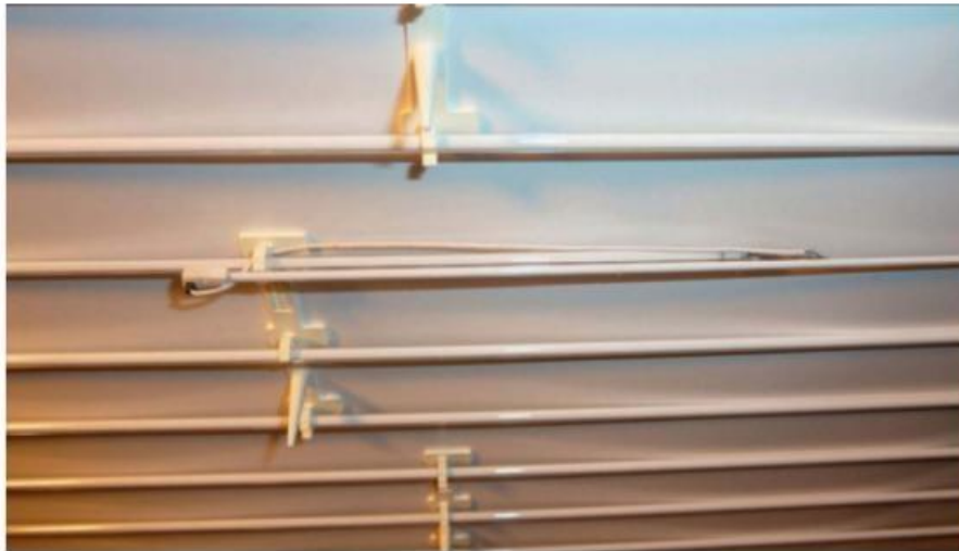
Figure 4-48. Réparation d'une dalle 46 pouces en associant deux tubes CCFL en série
