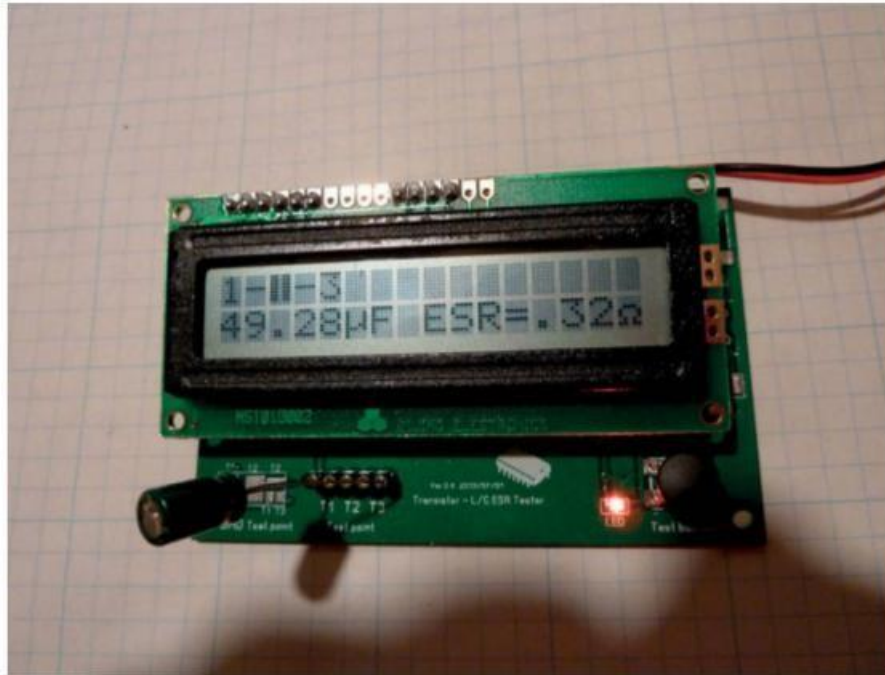
Figure 11-2. Contrôle d'un condensateur électrochimique de 47 \mu\text{F} 16 volts
