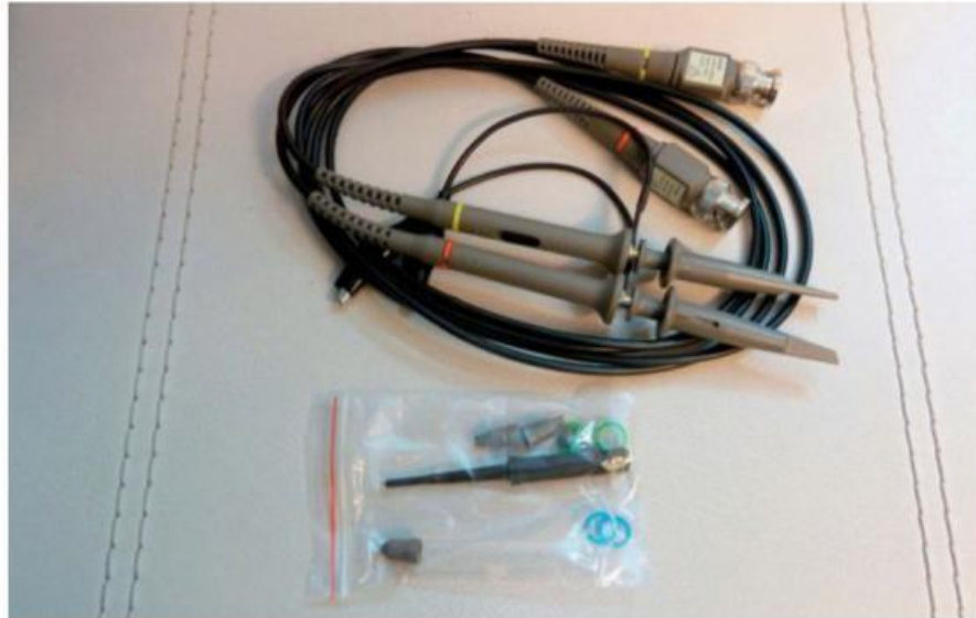
Figure 2-8. Sondes pour oscilloscope (diviseur par 1 et 10)
