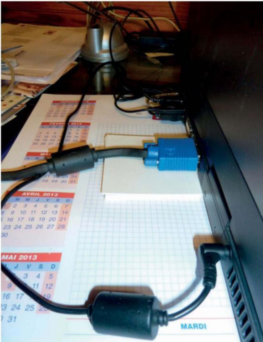
Figure 6-29. Connexions externes d'un ordinateur portable. Notez le soutien du connecteur VGA.
