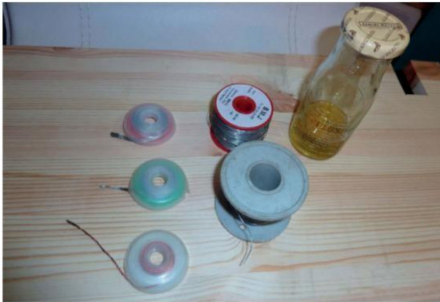
Figure 2-15. Tresse à dessouder, soudure et flux
