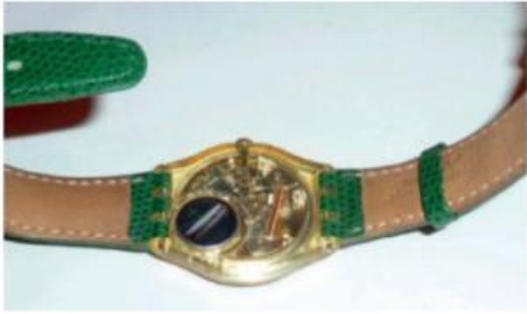
Figure 7-4. Montre avec capot protecteur de pile amovible
