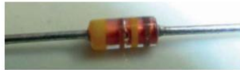
Figure 12-5. Exemples de marquage à anneaux de couleur (1N4148)
