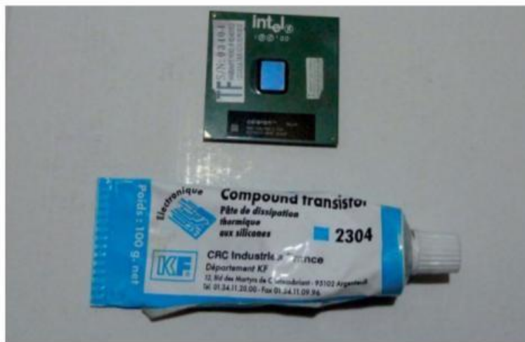
Figure 6-6. Microprocesseur et pâte thermique
