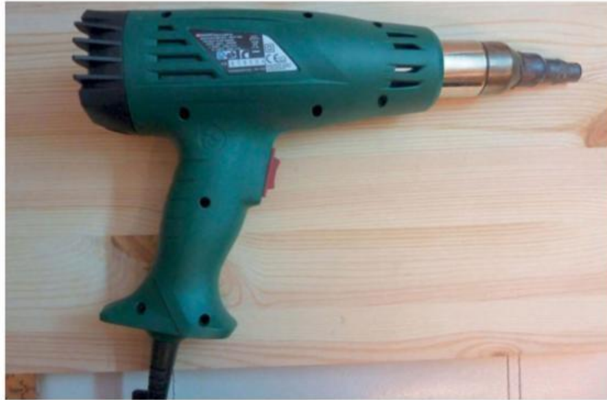
Figure 2-18. Décapeur thermique avec embout réducteur « maison »
