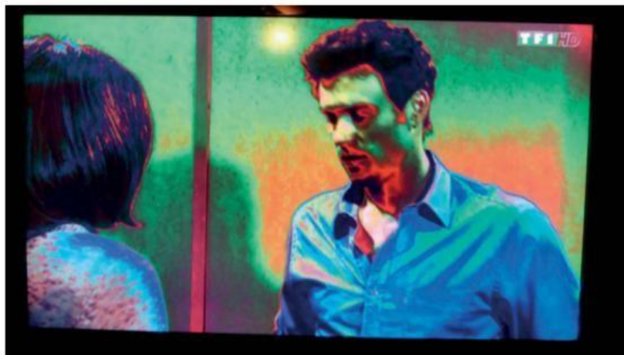
Figure 4-10. Exemple d'un défaut d'une carte T-Con
