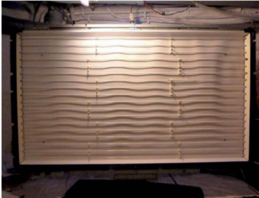
Figure 4-47. Intérieur d'un écran LCD dont le panneau LCD a été retiré
