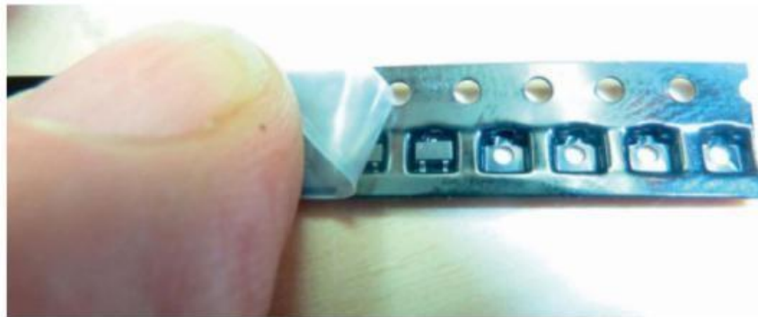
Figure 12-10. Ponts de diodes BAV99W (code A7) livrés en film perforé
