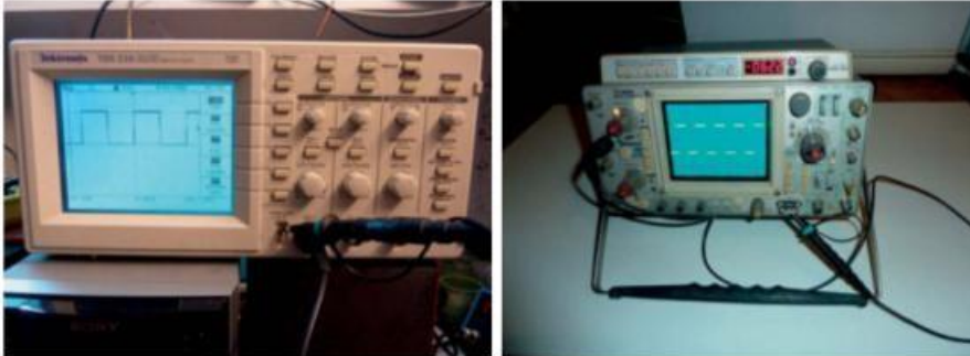
Figure 2-7. Réglage des sondes d'un oscilloscope numérique (à gauche) et analogique à multimètre intégré (à droite)
