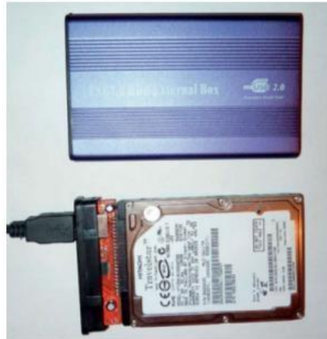
Figure 6-37. Disque dur d'ordinateur portable réutilisé dans un boîtier de disque externe USB
