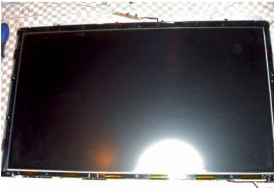
Figure 4-45. Cadre métallique enlevé, les films de connexion sont accessibles
