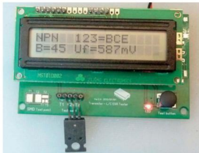
Figure 10-1. Contrôle d'un transistor NPN à l'aide du testeur
