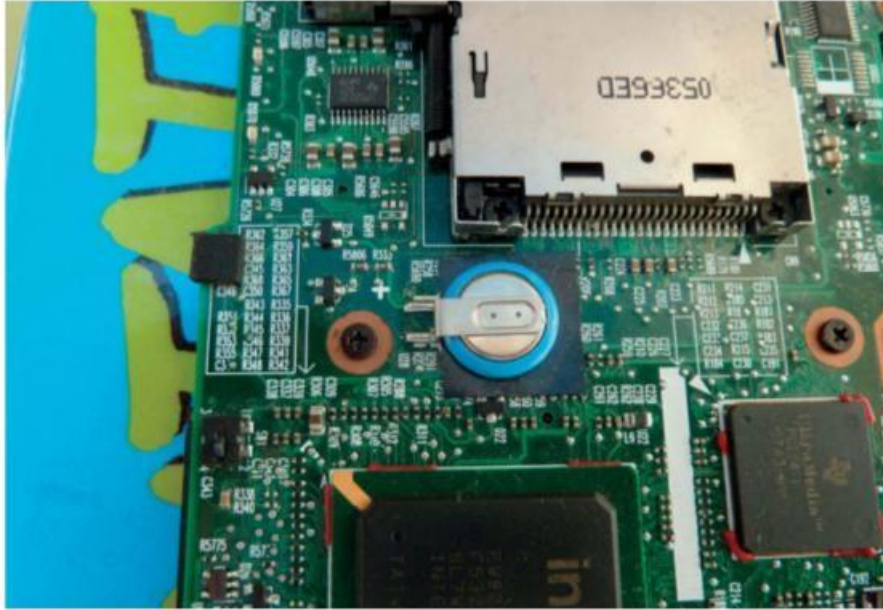
Figure 6-38. Batterie soudée sur carte mère
