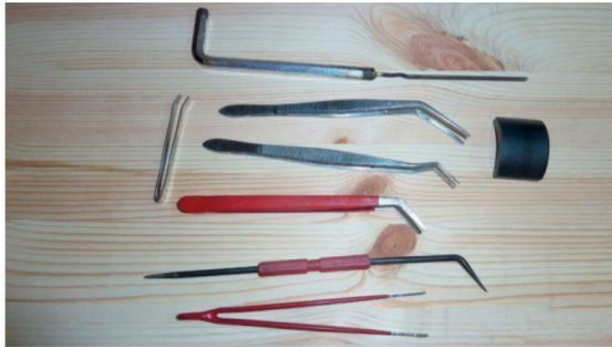
Figure 2-11. Quelques outils spéciaux dont un aimant et une clé Torx allongée
