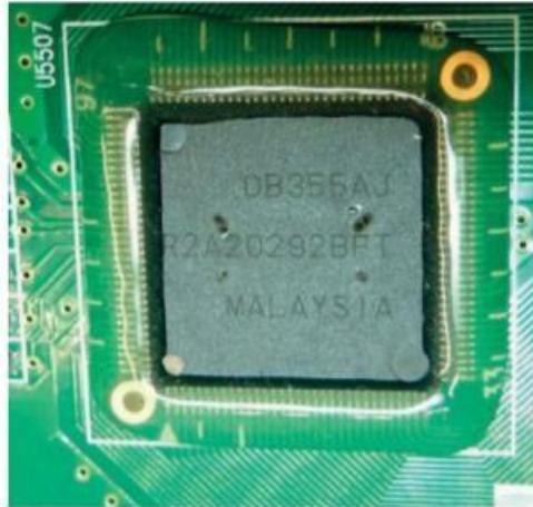
Figure 5-21. Détail d'un circuit R2A20292BFT (défectueux) soudé et protégé par colle souple
