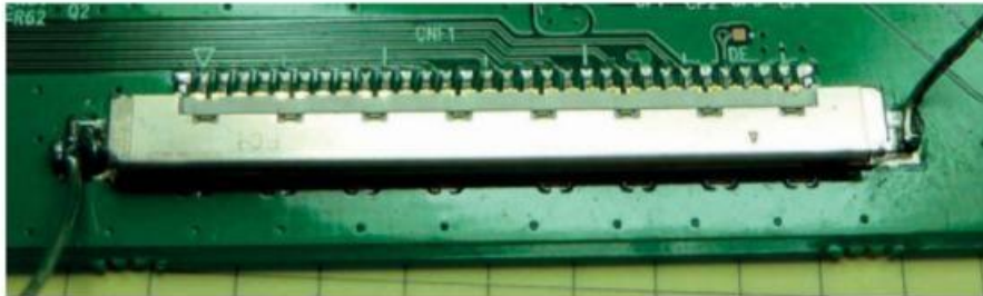
Figure 9-22. Connecteur femelle à languettes plates (connexion de signaux LVDS de téléviseur)
