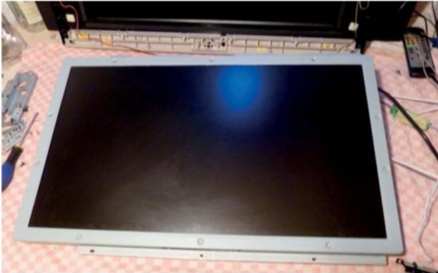
Figure 4-44. Il ne reste plus qu'à retirer le cadre métallique maintenant le panneau LCD
