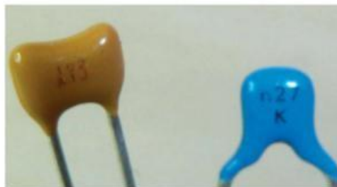
Figure 12-4. Exemples de marquage codifié de condensateurs
