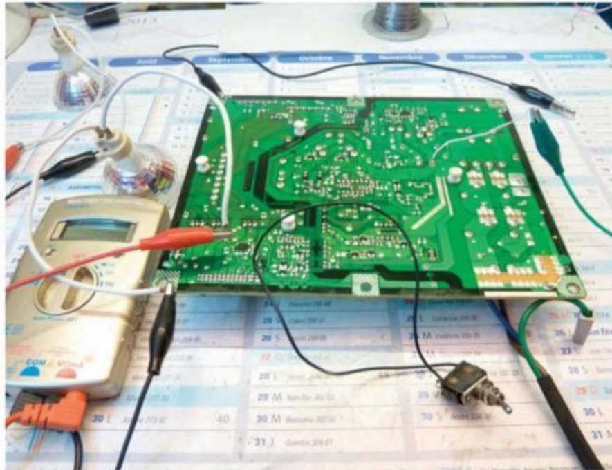
Figure 8-7. Carte d'alimentation en test autonome. Notez l'interrupteur et les lampes de charge.
