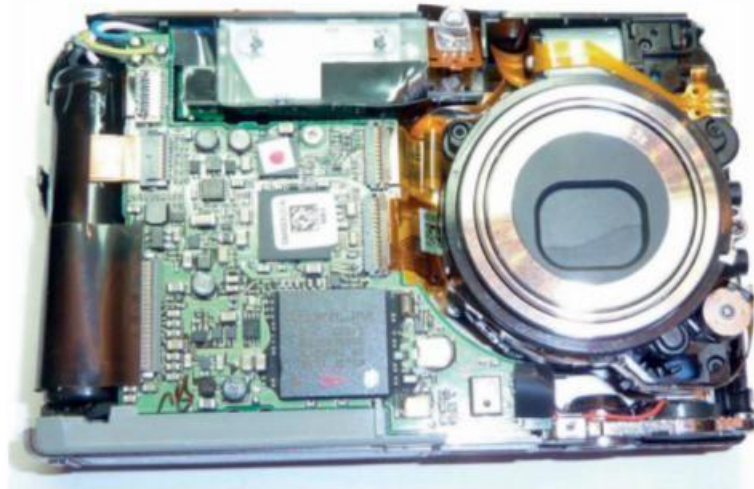
Figure 7-7. Démontage d'un appareil photo numérique à l'objectif bloqué
