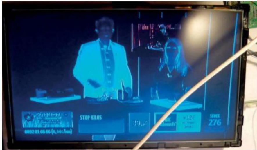
Figure 4-9. Exemple d'un défaut d'une dalle écran (image négative)
