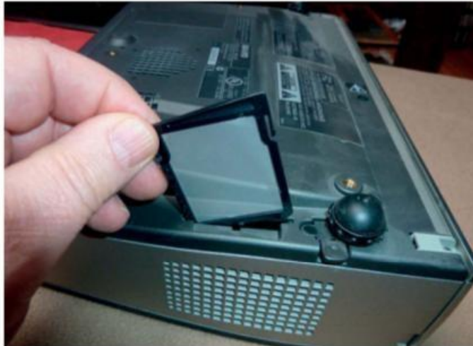
Figure 7-40. Démontage du filtre anti-poussière pour nettoyage
