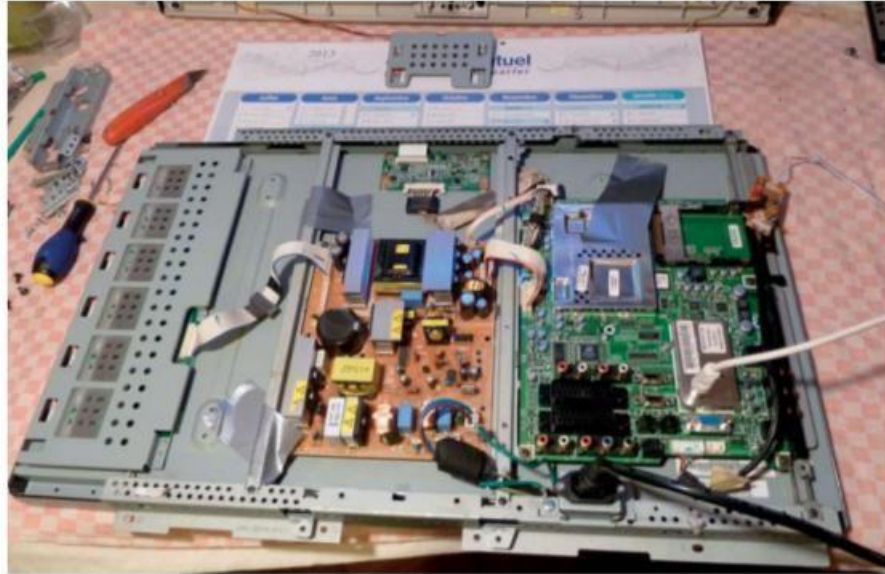
Figure 4-43. Dalle et circuits retirés du châssis de l'appareil, prêts pour test
