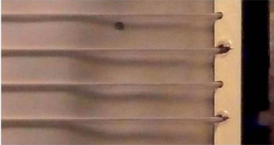
Figure 4-49. Échauffement du cache plastique d'un écran LCD au niveau connexion des tubes
