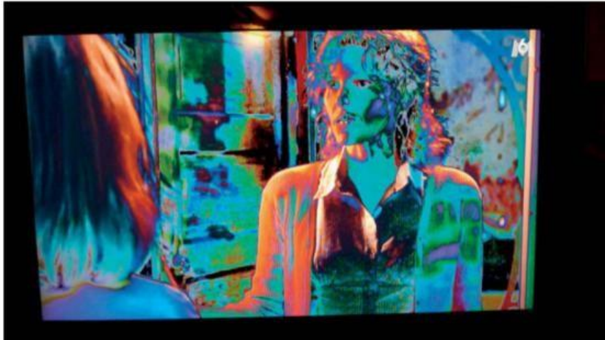
Figure 4-11. Exemple d'un défaut des circuits « gamma » d'une carte T-Con
