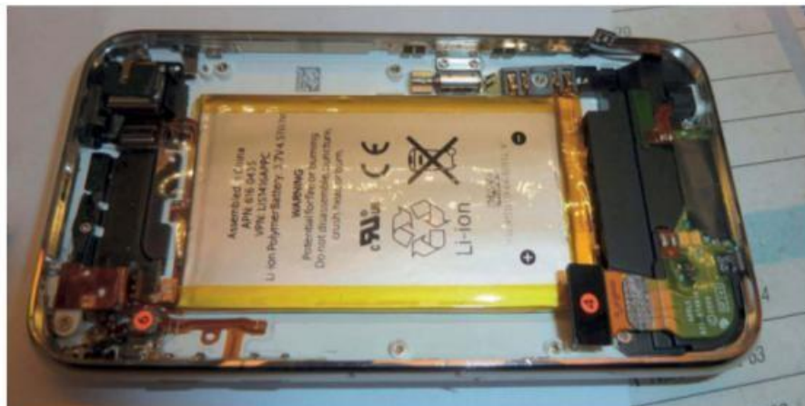
Figure 7-6. Démontage d'un smartphone doté d'un logo bien connu en vue de remplacer sa batterie
