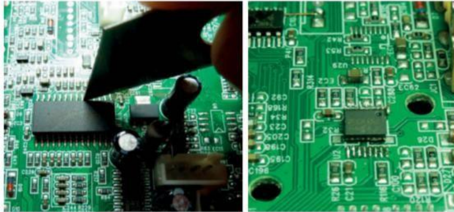
Figure 3-6. Découpe au cutter des broches de circuits intégrés
