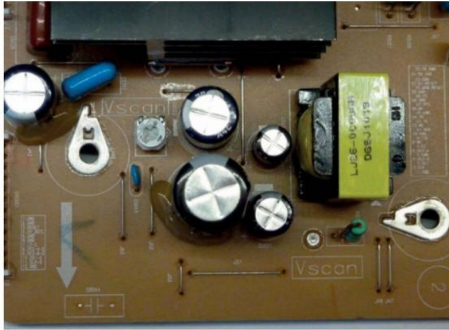
Figure 5-17. Réglage V_{scan} et son point de test (carte Y-scan)
