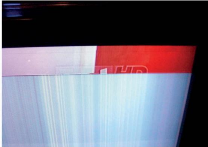
Figure 4-50. Défaut d'affichage qui n'a pu être réparé
