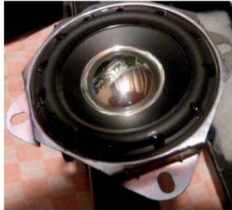
Figure 9-50. Réparation d'une membrane en mousse : pose des premiers points de collage
