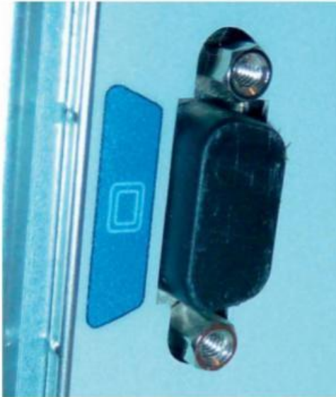
Figure 6-7. Connecteur VGA femelle masqué par un cache sur une tour de PC
