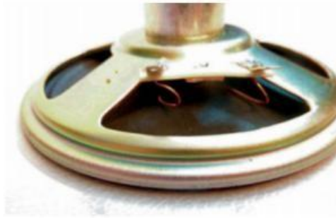
Figure 9-49. Vue des connexions d'une membrane
