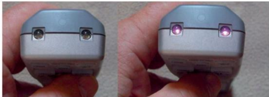
Figure 7-41. Vérification rapide d'une télécommande infrarouge
