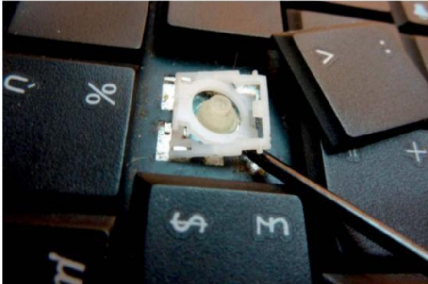
Figure 6-36. Touche de clavier démontée et articulation maintenue par un tournevis pour la photo
