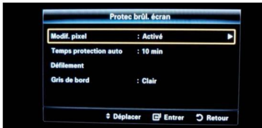
Figure 5-32. Option de protection antimarquage d'un téléviseur plasma
