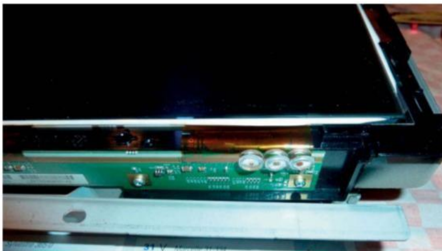
Figure 4-55. Rétablissement d'une liaison entre le circuit imprimé et un film côté vertical
