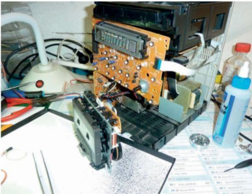
Figure 7-16. Test d'un mécanisme de lecteur/enregistreur de cassettes
