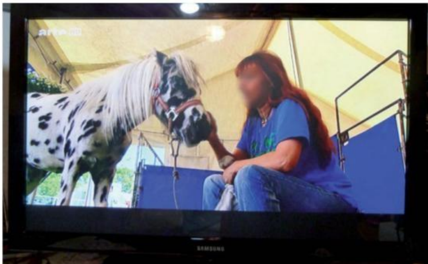
Figure 5-24. Remise en fonction du téléviseur, une bande noire apparaît en bas de l'écran
