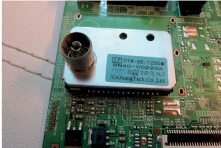
Figure 4-39. Tuner reconnaissable à sa prise antenne
