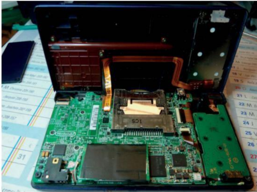
Figure 7-1. Ouverture d'une console double écran
