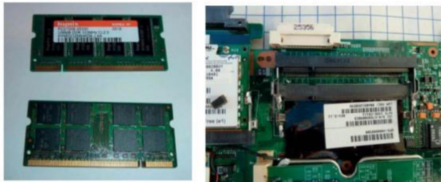
Figure 6-24. Barrettes mémoire d'ordinateur portable (à gauche) et leur support (à droite)
