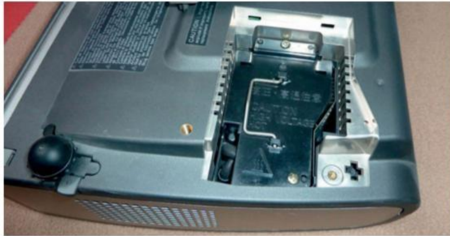
Figure 7-36. Trappe d'accès à la lampe d'un Tri-LCD
