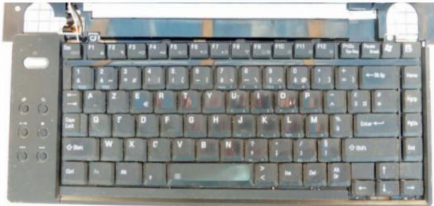
Figure 6-20. Clavier dans son emplacement du capot supérieur
