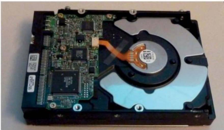
Figure 6-18. Disque dur IDE 3,5 pouces pour ordinateur de bureau
