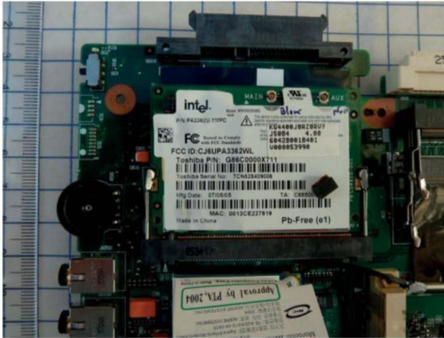
Figure 6-35. Carte Wi-Fi d'un ordinateur portable. Notez les connecteurs d'antenne.
