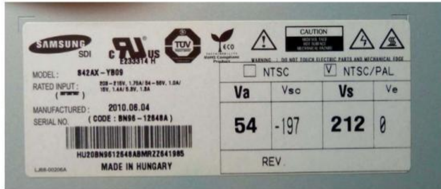
Figure 5-6. Étiquette informative des tensions requises pour une dalle plasma
