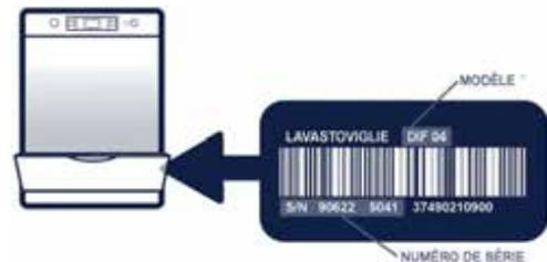
Sur le schéma ci-dessus, la flèche montre que la plaque signalétique se trouve sur un des côtés de la porte.
