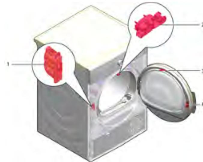
Fig. 24: Système de verrouillage de porte avec micro-interrupteur
