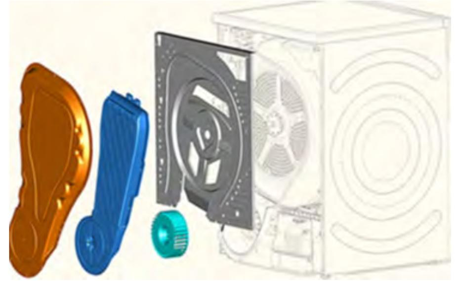
Fig. 27: Monter la paroi arrière du kit de réparation.
