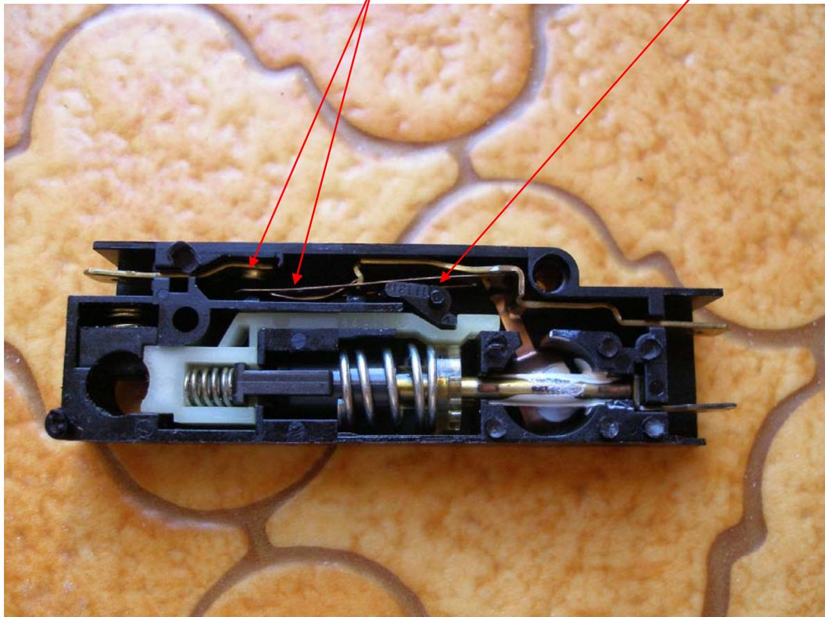
J'ai donc décidé de faire passer cette lamelle sous celle-ci afin d'assurer le contact (désolé pas de photo de cette inversion). Depuis ma machine fonctionne parfaitement et la sécurité est assurée.
