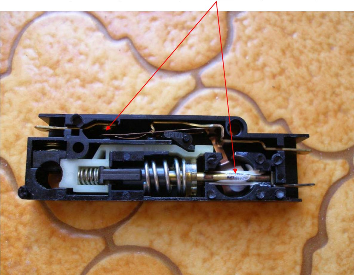
Malgré ce nettoyage ma machine ne fonctionnait pas. Je me suis aperçu que ce levier ne permettait plus d'assurer le contact entre ces deux lamelles.
