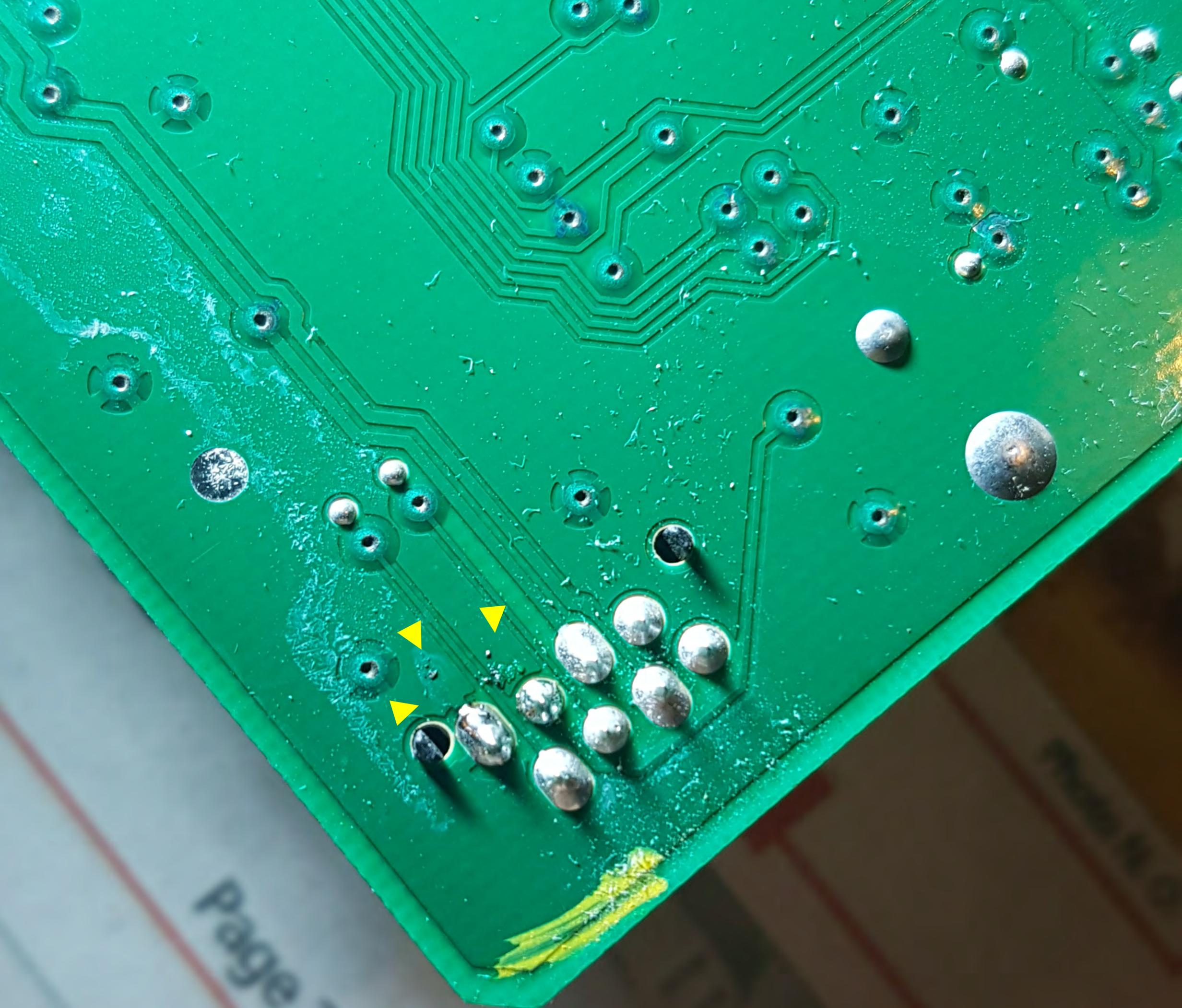
**Des billes de soudure, des poussières et des traces blanches apparaissent sur le circuit imprimé à proximité du connecteur du panneau de commandes sensibles**
