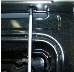
Retirer les manettes et les vis sous le bandeau et tirer vers vous pour le déboîter, puis retirer la tôle sur le dessus du four (4 vis généralement)
