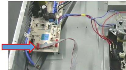
Déconnecter la limande de la carte de commande (vers le haut) « Il arrive que de l'oxydation apparaisse dans ce connecteur, un bon nettoyage avec du spray nettoyant contact électrique pourrait refaire fonctionner l'appareil »
