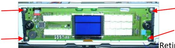
Retirer les 4 vis de la carte de commande et la remplacer.
