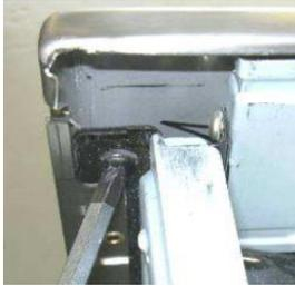
Sortir le four de son logement, retirer les vis de chaque côté à l'arrière du bandeau du four.
