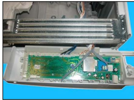
b. Dévisser les vis et détacher les clips qui fixent le boîtier carte au bandeau de commande.
