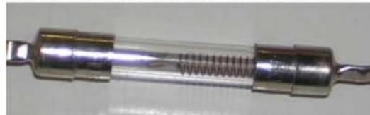
La plupart du temps ( mais pas toujours ) , le fusible est équipé dans sa structure d'un ressort de rappel. Le fusible est constitué, de fil fusible, alors là rien de bien méchant, du bête fil fusible pour tenir en fusion lente sous sept cent milliampères. Mais que se passe-t-il quand il est décidé à fondre ?
