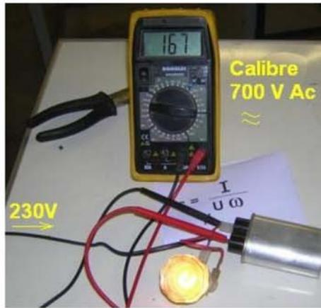
Dans l'exemple, la tension lue aux bornes du condensateur est de 167 V
