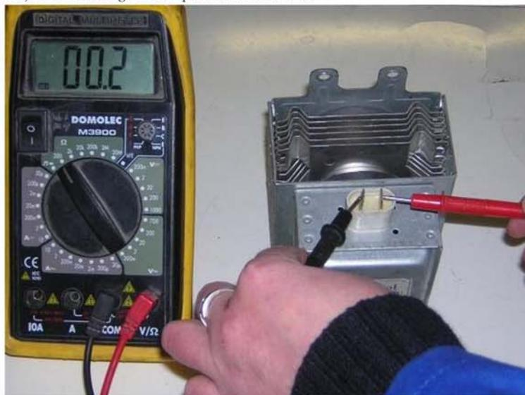
*Sur la photographie, le magnétron est démonté !
