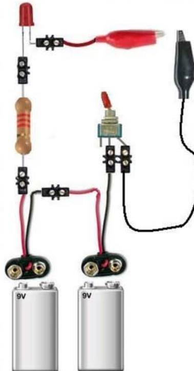
Quand le montage est réalisé, il doit fonctionner en mettant ensemble les deux pinces crocodile. La diode ne s'allume pas, intervertissez les pattes de la diode, ensuite le montage doit s'allumer !
