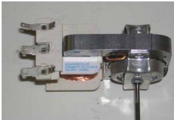
Et oui! Dès qu'un constructeur est en état de grappiller le moindre picailon, il ne se prive pas ! Donc il est remarquable que sur certains modèles de ventilateur, il y ait trois connecteurs, une phase, un neutre, le troisième présente à la mesure une tension d'une trentaine de volts. Cette tension intermédiaire est piquée sur la bobine du moteur du ventilateur. Celui-ci fait donc à la fois office de ventilateur, mais aussi celui d'auto transformateur pour alimenter le moteur de plateau.
