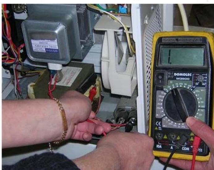
Regardez bien la photographie, la mesure est réalisée entre le point de sortie de l'enroulement haute tension, et le point de connexion sur le condensateur.
