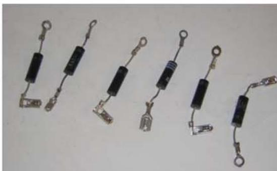
Bref grâce à cette diode, la tension alternative au départ est redressée. Se présente à l'entrée du magnétron un courant presque continu, plutôt proche d'un courant pulsé, mais dont la différence de potentiel est proche de cinq milles volts!
