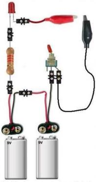
Quand le montage est réalisé, il doit fonctionner en mettant ensemble les deux pinces crocodile. La diode ne s'allume pas, intervertissez les pattes de la diode, ensuite le montage doit s'allumer! Notre montage est fonctionnel si la diode s'allume pendant que les pinces crocodiles se touchent!
