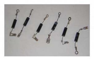
Bref grâce à cette diode, la tension alternative au départ est redressée. Se présente à l'entrée du magnétron un courant presque continu, plutôt proche d'un courant pulsé, mais dont la différence de potentiel est proche de cinq milles volts!
