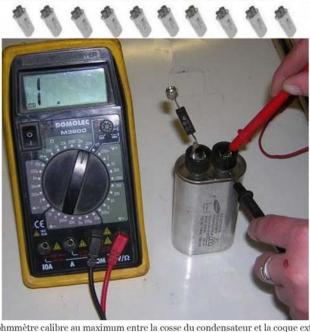
g- Mesurez en ohmmètre calibre au maximum entre la cosse du condensateur et la coque extérieure en aluminium. La mesure doit indiquer "tend vers l'infini".
