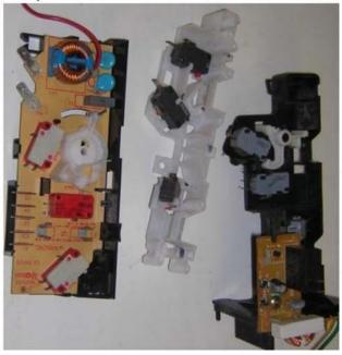
Le crochet de porte est présent sur la porte, il est solidaire du second crochet, en réalité c'est un seul élément!
