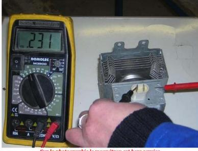
Sur la photographie le magnétron est hors service. Il y a passage de courant entre filament et masse.
