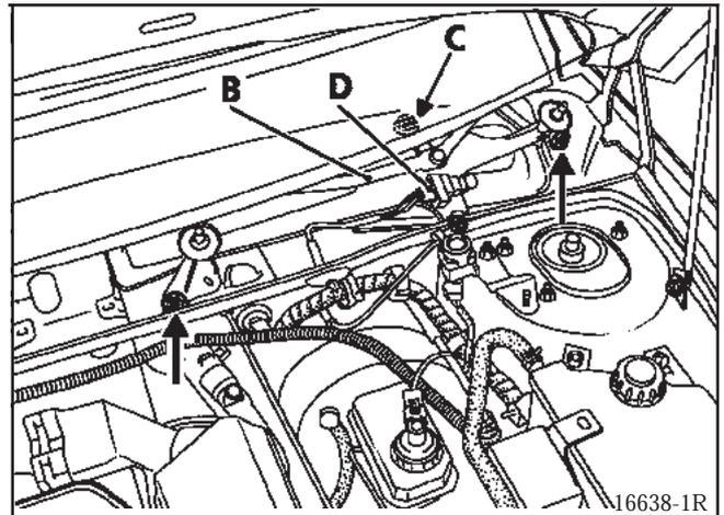
Dégager le mécanisme du point de fixation (C) et le déposer sans forcer sur le bas du pare-brise.
