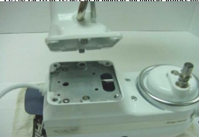
Fig. 83 La vis de réglage de la hauteur du batteur utilisée pour régler le jeu de 1/16 "entre le bol et le batteur.
