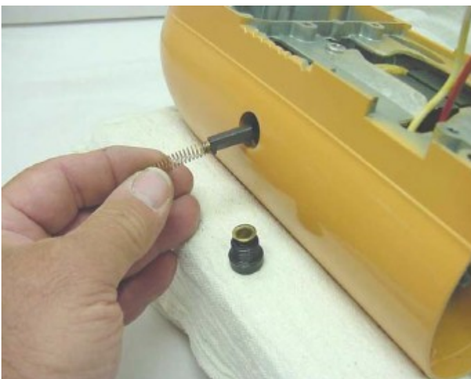
Fig.29 les capuchons du porte-balais sont desserrés pour accéder aux balais pour le retrait. Assurez-vous de marquer l'orientation.
