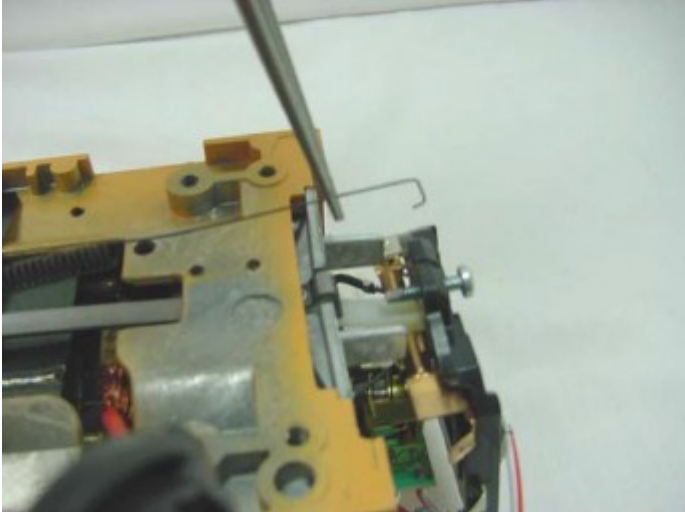
Fig. 17 Décrochez le ressort de la carte de commande.
