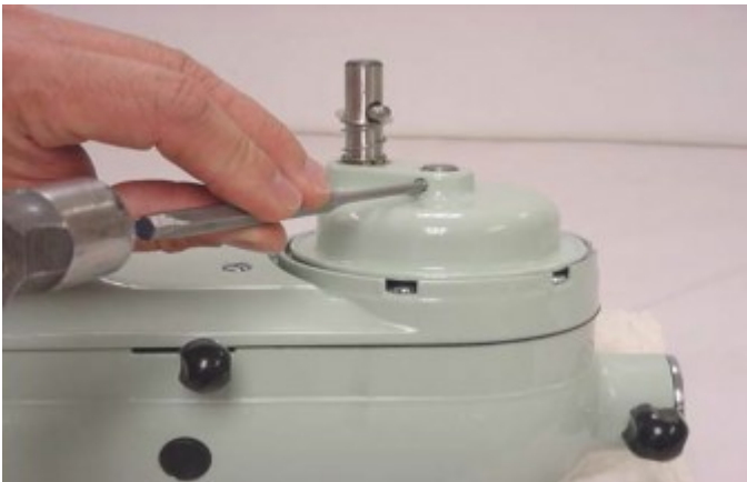
Fig.6 Retrait de l'axe de rainure qui maintient le planétaire sur l'arbre central vertical Une fois la goupille sortie, le planétaire peut être retiré de l'arbre central. À l'aide de deux (2) tournevis, soulevez le planétaire et retirez-le de l'arbre (Fig. 7).
