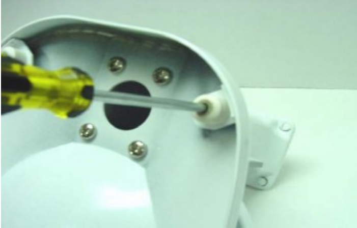
Fig. 95 Deux vis # 10-24 x 1/4 "maintiennent le loquet à ressort du bol en place.
