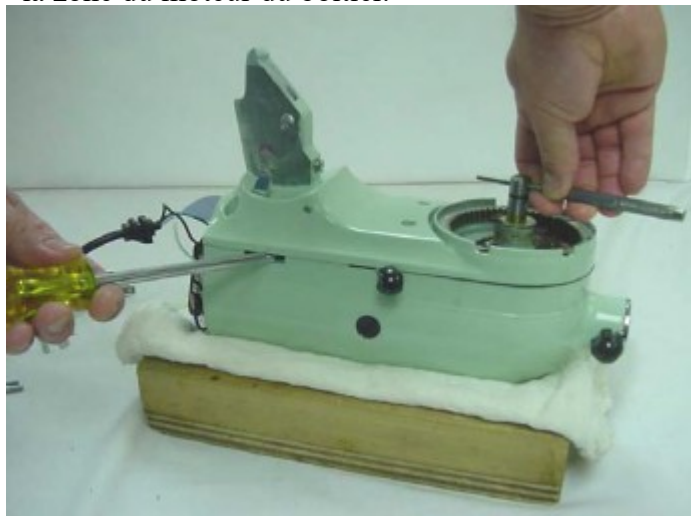
Fig. 12 Tout en soulevant l'arbre central, utilisez un tournevis pour soulever délicatement le couvercle inférieur du boîtier.
