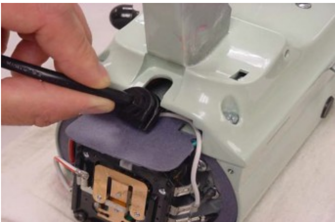
F. Retirez le cordon d'alimentation du capot inférieur en faisant glisser la décharge de traction moulée hors de la fente du capot inférieur (Fig. 8).
