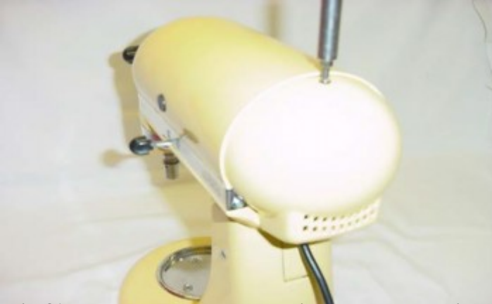
Fig. 81. Remplacez la bande de garniture sur le carter d'engrenage après avoir réglé les vitesses.
