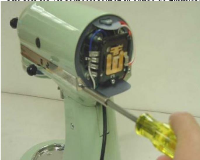
Fig.2 Le trimband peut être retiré après avoir retiré les vis du trimband.
