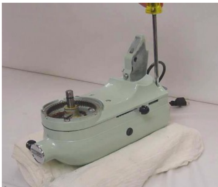
Fig. 10 Retrait des 5 vis spéciales retenant l'engrenage interne dans le couvercle inférieur.
