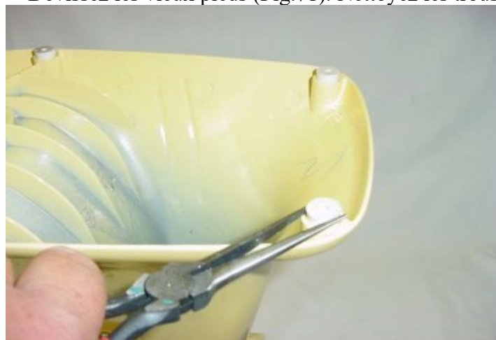
Fig. 71 Les pieds du socle doivent être remplacés sur les mélangeurs plus anciens.
