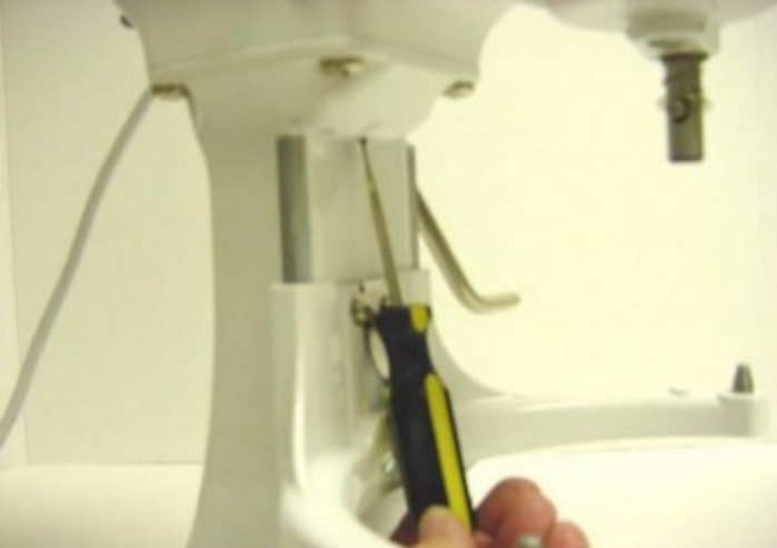
Fig. 97 Réglage du batteur à la hauteur du bol à l'aide de la vis de réglage.
