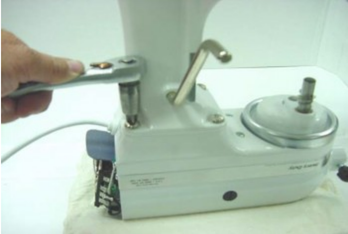
Fig. 84 Quatre vis à tête Phillips ronde doivent être retirées pour remplacer l'ensemble de support de bol.
