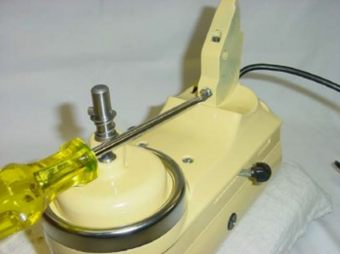
Fig. 69 La vis de réglage a un insert en nylon et ne doit pas être lâche dans les filetages.
