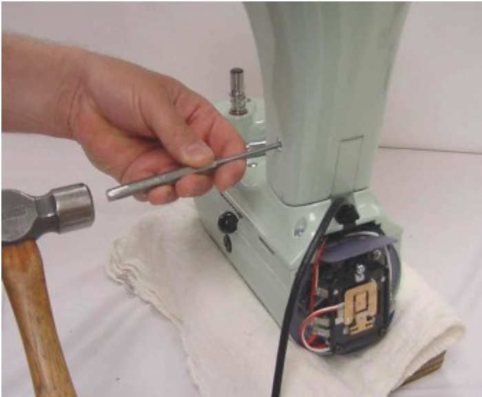
Fig. 3 Desserrez la vis de réglage de l'axe de charnière pour retirer le socle du couvercle inférieur .
