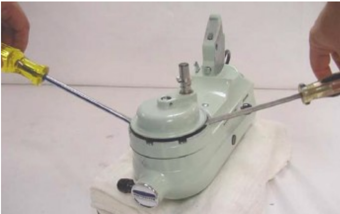
Fig. 7 Utilisez deux tournevis pour retirer le planétaire de l'arbre.
