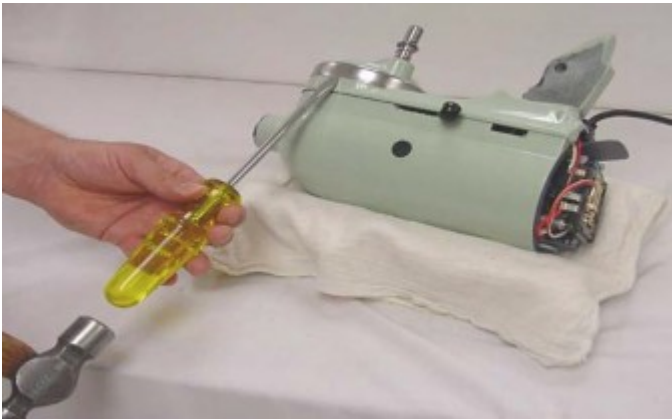
Fig. 5 Le Drip Cup est bien ajusté et doit être démarré en le tapotant. Avec un poinçon à dérive de 5/32 ”, retirez la goupille de rainure qui maintient le planétaire à l'arbre central vertical (Fig. 6).
