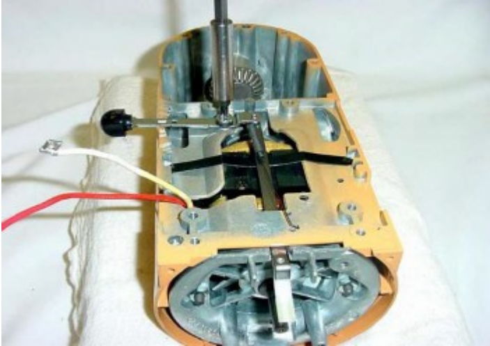
Fig. 44 Fixation de la vis pivot au carter d'engrenage après avoir placé la rondelle de tension.
