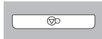
Appuyez et maintenez enfoncée la touche **ARRET/ANNULER** jusqu'à ce que "**L**" apparaisse sur l'afficheur et qu'un signal sonore retentisse. La **SÉCURITÉ ENFANT** est enclenchée.
