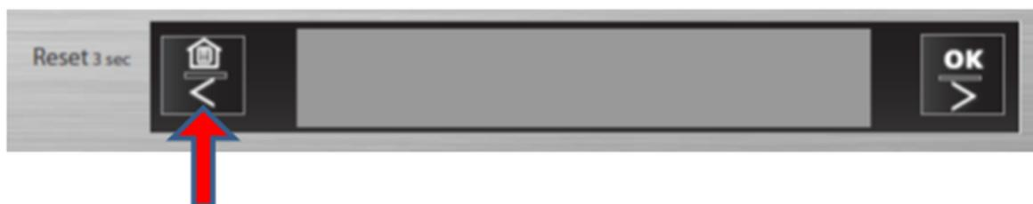
Une fois dans le mode Entretien sur les 2 modèles LCD ci-dessus, utilisez les touches de navigation (« < » et « > ») pour sélectionner la fonction d'entretien souhaitée qui s'affiche à l'écran et appuyez sur la touche « OK » pour entrer dans la fonction sélectionnée, suivez ensuite les instructions qui s'affichent à l'écran pour exécuter les fonctions.
