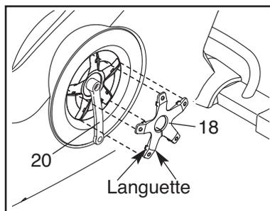
À l'aide d'un tournevis à tête plate, desserrez les attaches situées sur chaque point du Couvercle du Disque (18) gauche. Bougez légèrement le Couvercle du Disque gauche par-dessus le Bras Gauche du Pédalier (20) puis enlevez le Couvercle du Disque gauche.
