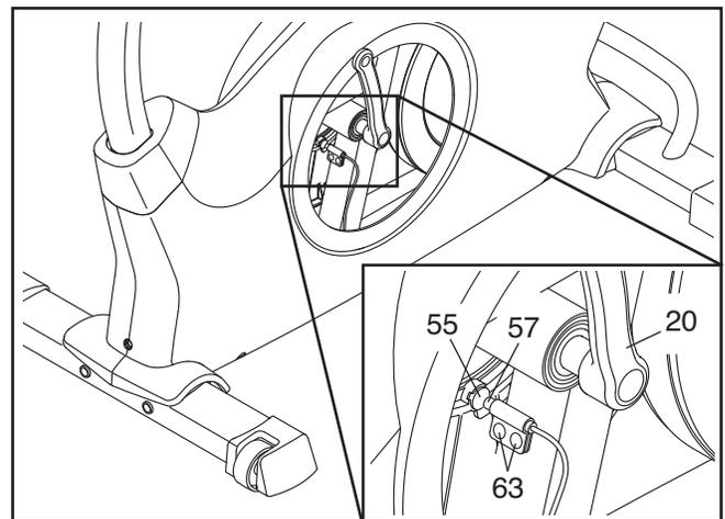
Ensuite, tournez le Bras Gauche du Pédalier (20) jusqu'à ce qu'un Aimant (55) soit aligné avec le Capteur Magnétique (57). Faites glisser légèrement le Capteur Magnétique vers l'Aimant ou dans la direction opposée. Puis, resserrez les Vis à Collerette de M4 x 12,7mm (63).
