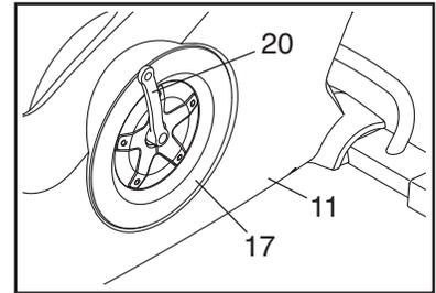
Tournez le Disque de la Pédale (17) gauche dans le sens des aiguilles d'une montre pour le détacher du Panneau Gauche (11). Puis, bougez le Disque de la Pédale gauche vers le haut puis enlevez-le du Bras Gauche du Pédalier (20).
