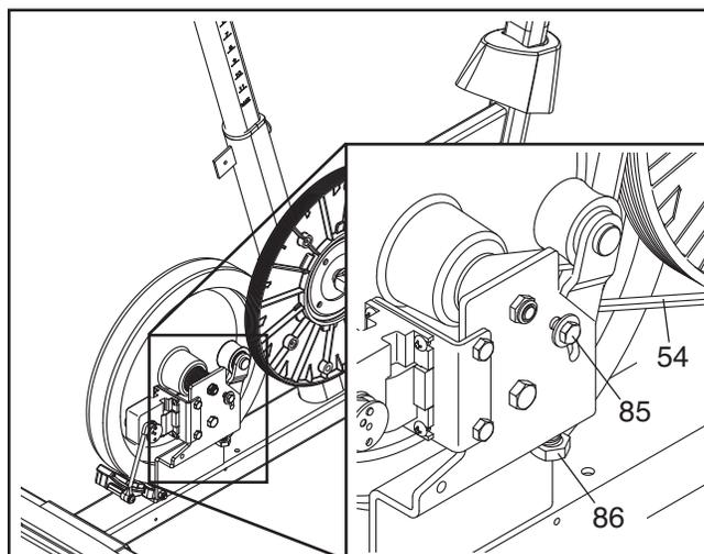
Une fois que la Courroie de Traction (54) est tendue, serrez la Vis Hexagonale de M6 x 20mm (85).
