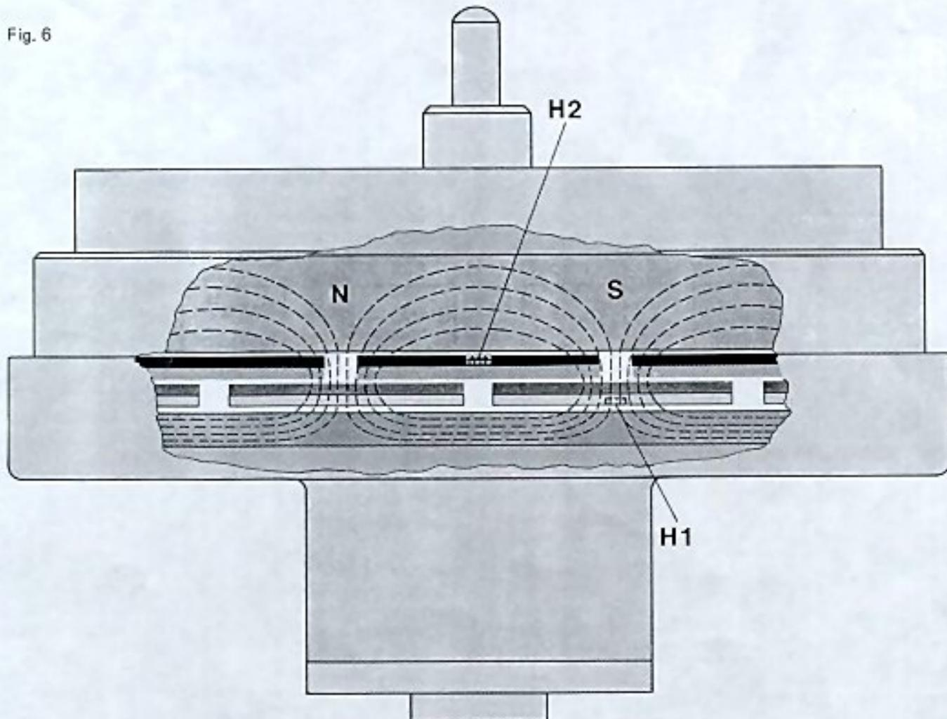
Da sich der Hallgenerator H 2 während dieser Zeit in der neutralen Zone des Magnetpolpaares befindet, entstehen an seinen Anschlüssen 7 und 5 keine Hallspannungen. Die mit diesen Anschlüssen verbundenen Transistoren T 6 und T 7 sind daher ebenfalls gesperrt.
