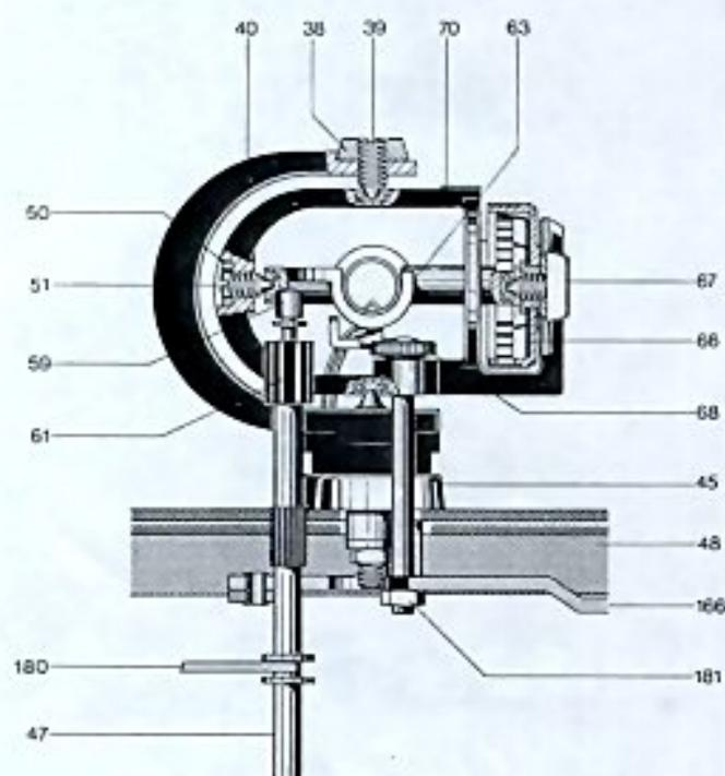
Fig. 12 Tonarmlagerung (Unteransicht)
