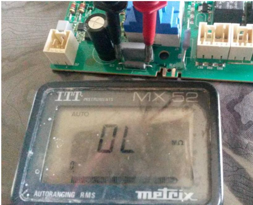
Si l'ohmmètre indique l'infini ou plusieurs mégohms, la résistance est coupée
