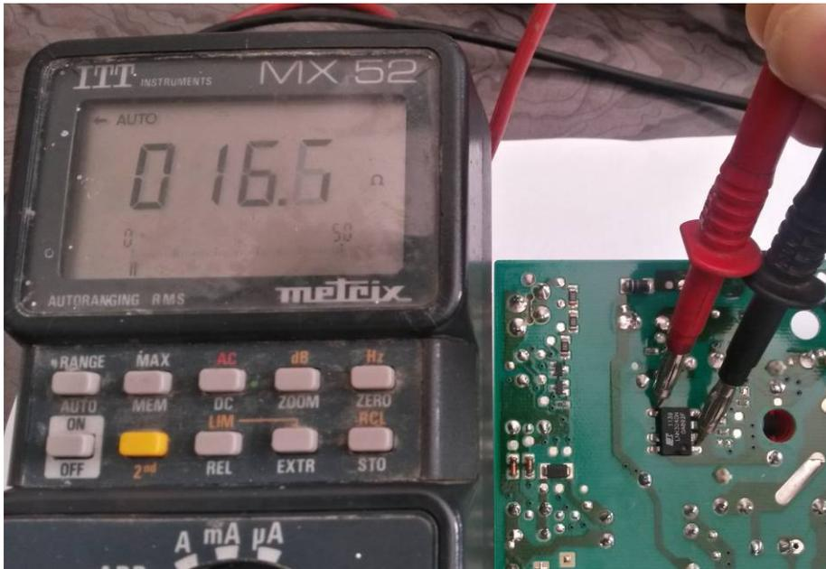
Si l'ohmmètre indique zéro ohm ou une faible valeur, le LNK304 est en court circuit
