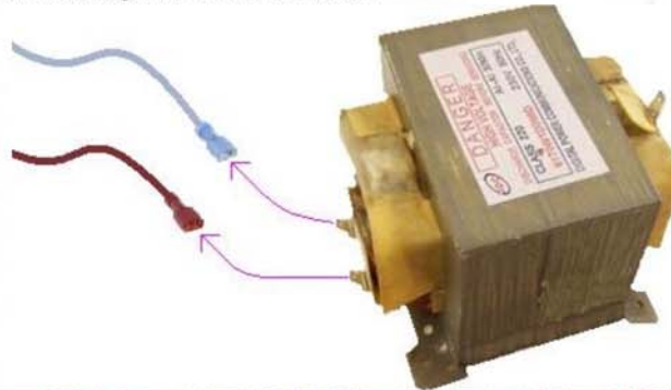
3- Débranchez les cosses du primaire du transformateur.
