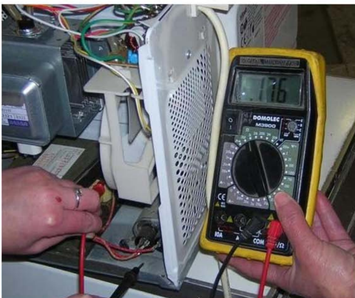
b- Mesure du secondaire du transformateur. Mesurez en ohmmètre calibre 1 ou 2 kilo-ohms (un ou deux kilo-ohms), la résistance entre sortie haute tension et le point de masse du câble d'alimentation (fil jaune et vert). Vous devez trouver entre 50 et 230 ohms .(Cinquante et deux cent trente ohms).
