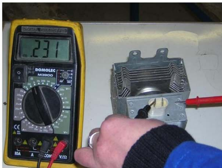
Sur la photographie le magnétron est hors service. Il y a passage de courant entre filament et masse.
