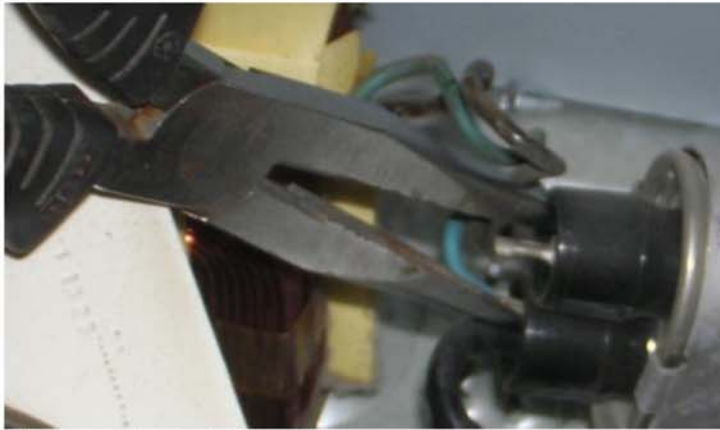
3- Débranchez les cosses du primaire du transformateur.
