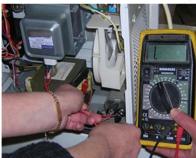
Regardez bien la photographie, la mesure est réalisée entre le point de sortie de l'enroulement haute tension, et le point de connexion sur le condensateur. Le calibre de l'appareil de mesure est sur 2K ( deux milles ohms).
