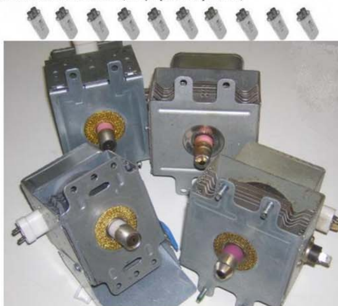
Sur la photographie, il est possible d'apercevoir un amorçage sur l'antenne du magnétron en haut à droite ! Ce magnétron est considéré comme étant hors service !
