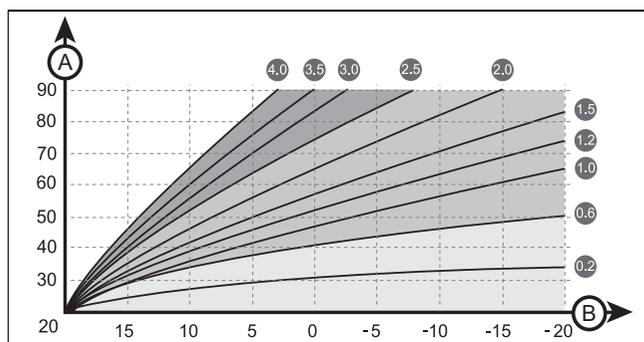
A Température de départ du chauffage      B Température extérieure
