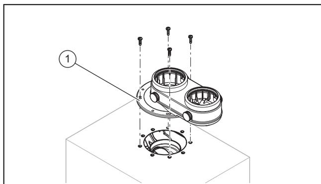
1. Positionnez la pièce de raccordement (1) sur le produit. Le raccordement d'alimentation en air peut être orienté vers la gauche ou vers la droite.
