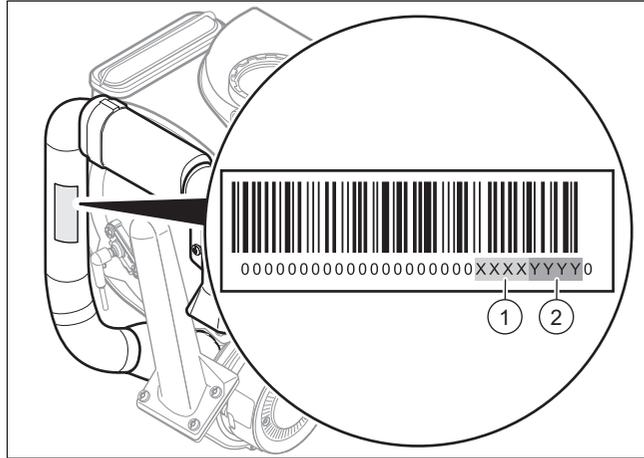
2. Consultez l'étiquette collée sur le tube d'entrée d'air pour connaître les vitesses min. (1) et max. (2).
