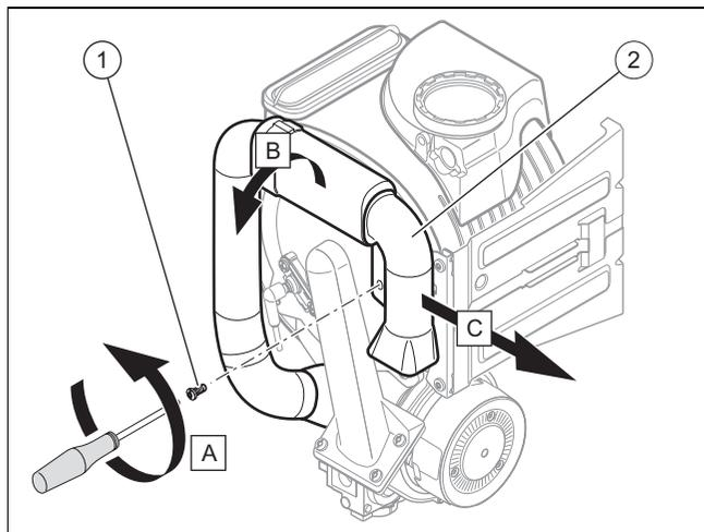
1. Retirez la vis de fixation du tube d'entrée d'air (1) et enlevez le tube d'entrée d'air (2).
