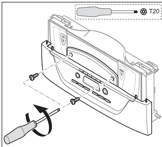
1. Démontez les vis de fixations et retirez la façade.
