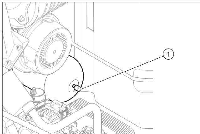
1. Faites chuter la pression sur le circuit sanitaire.
