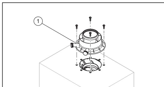
1. Positionnez la pièce de raccordement (1) sur le produit.
