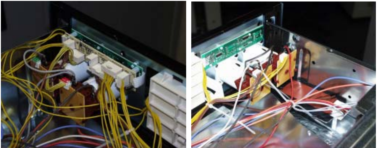
Illustr.: Éléments électroniques de saisie HOC2000 et Module de saisie à l'état monté
