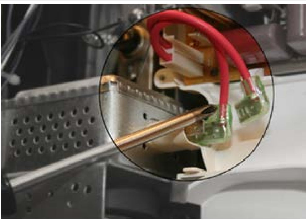
Bornes fil de chauffe magnétron
