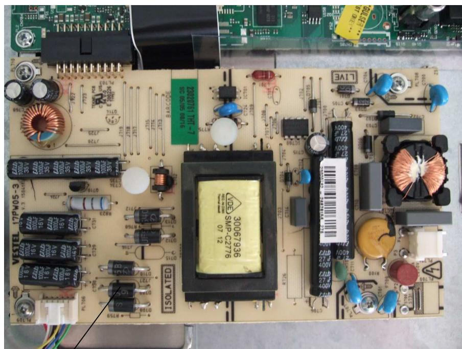
Ces 3 diodes Zener conduisent dans les 2 sens !!!! ( mesure avec Métrix en position 100Ohms
