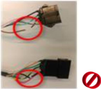
5. Débrancher les connexions pour vérifier l'état des broches et les repositionner si elles sont tordues.
