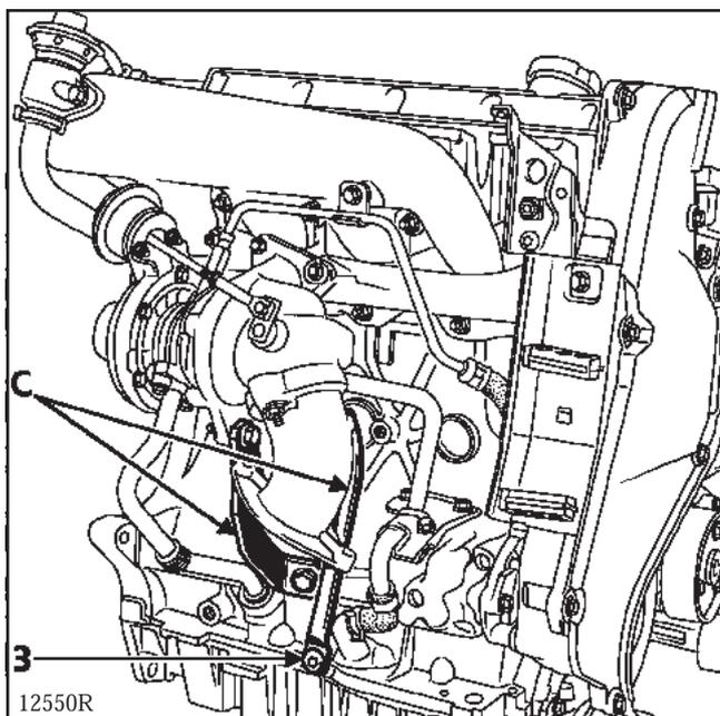
**NOTA :** la vis (3) se dépose avec un embout étoile de 50 (le raccourcir de la cote X = 13 mm) et une clé mixte de 8.
